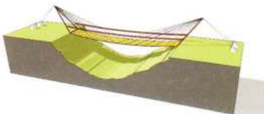
Passerelle haubanée, tablier léger
