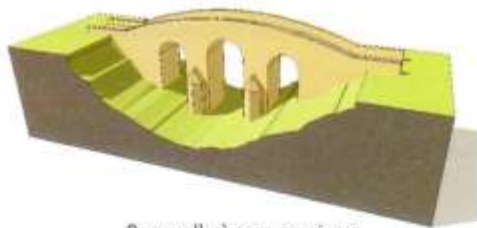
Passerelle à arcs en pierre
