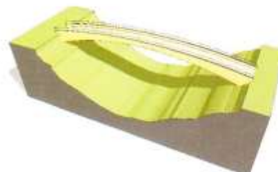
Arc béton coulé en place
